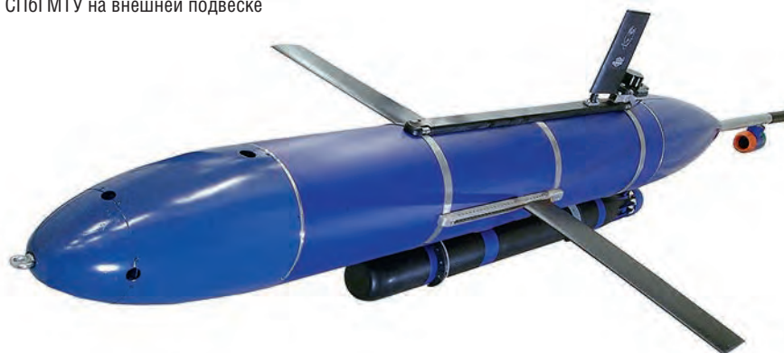
АНПА Глайдер 2.0 с макетом АНПА экологического мониторинга СПбГМТУ на внешней подвеске
