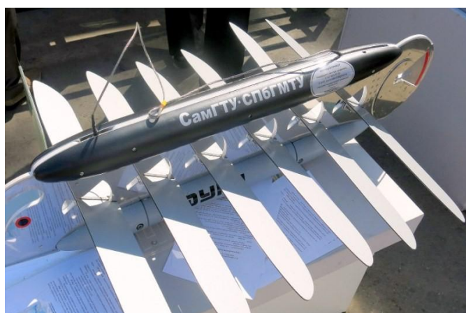
Рис. 4. Подводный модуль волнового глайдера СамГТУ-СПБГМТУ
