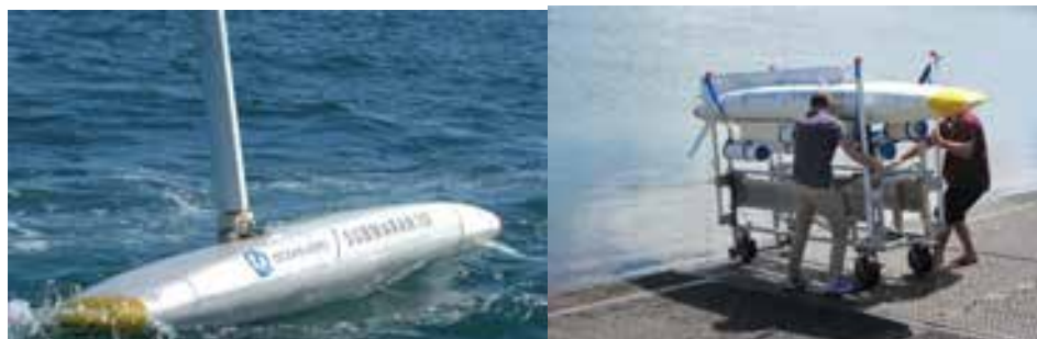
Рис. 3. Подкласс гибридных необитаемых аппаратов, обеспечивающих смешанный (надводный/подводный) режим функционирования и использующих глайдерный принцип движения (Submaran S10)
