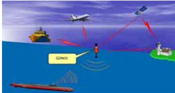
Рис. 7. Ретранслятор как средство преодоления границы раздела сред
