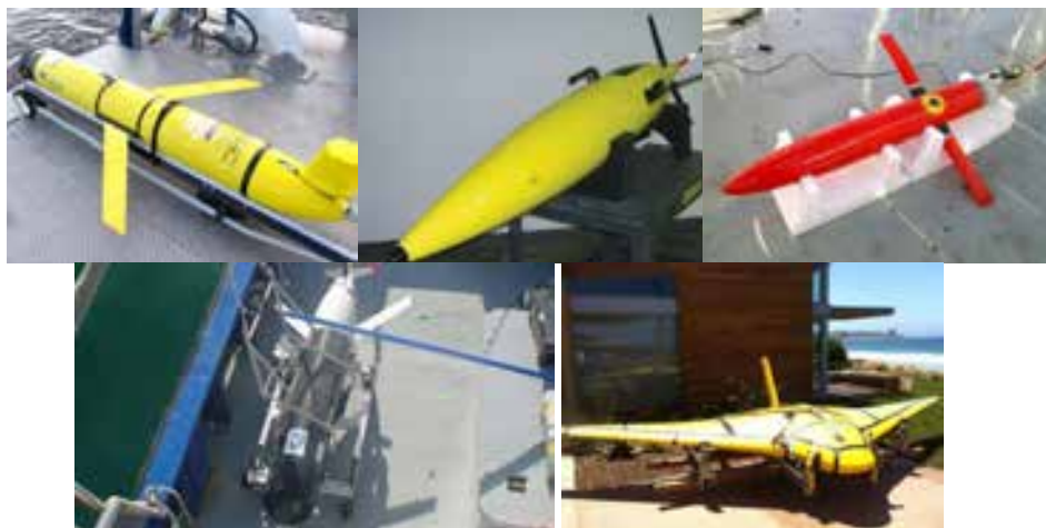
Рис. 1. Подкласс подводных глайдеров ( Slocum , SeaGlider , Spray Glider , ANT Littoral Glider , ZRay2 )
