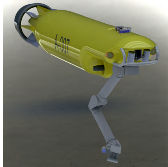
Рис. 10. Концепт проект ФГОУ ВО СПб ГМТУ и ЗАО «НПП ПТ «Океанос» АНПА с манипуляторным комплексом
