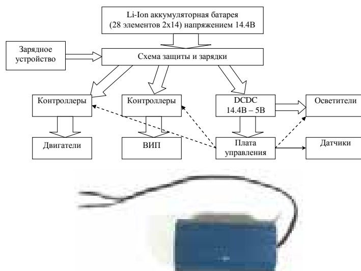
Рис. 7. Слева направо: структурная схема системы энергообеспечения АНПА-М; аккумуляторная сборка
