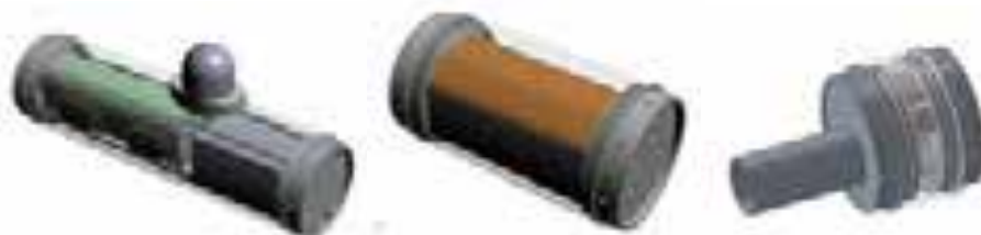
Рис. 12. 3D-модели разработанных модулей прочного корпуса (слева направо): электроники и гидроакустики, энергообеспечения (АКБ), СИП
