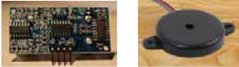
Рис. 4. Плата вычислительного модуля ультразвукового сонара и пьезоэлектрическая антенна сонара
