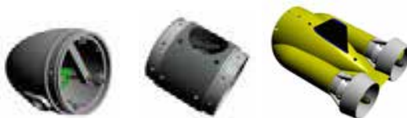
Рис. 13. 3D-модели разработанных «мокрых» модулей: носовой модуль, модуль ПУ, кормовой модуль
