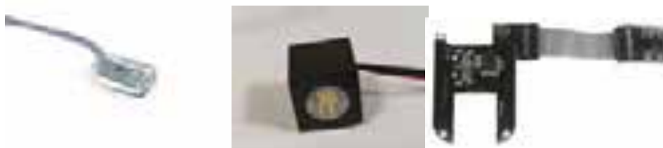
Рис. 6. Слева направо: датчик давления, температуры, крена и дифферента (OpenROV IMU/Compass/Depth Module); осветитель (OpenROV External Light Cube); модуль видеочамеры (Aptina RB HD Camera Cape/ BeagleBone Black A0-01)
