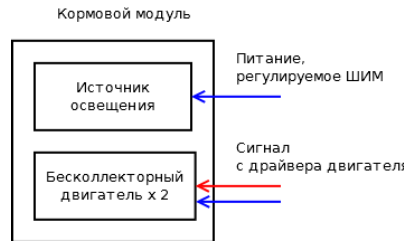
Рис. 19. Функциональная схема кормового модуля
