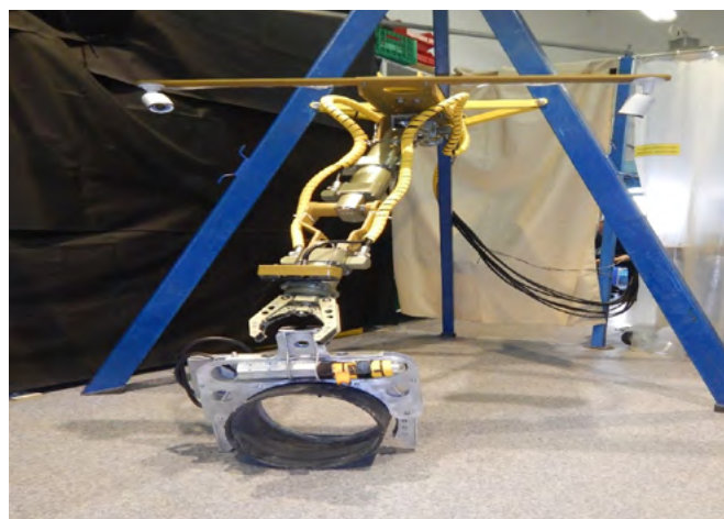
Рис. 20. Автономный манипуляторный комплекс АНПА типа «Глайдер» разработки СПбГМТУ / АО «НПП ПТ «Океанос» на стендовой отработке размещения и типовых операций по размещению донных сейсмо-приёмников.
