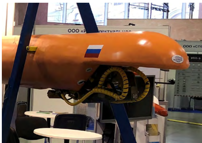
Рис. 20. Автономный манипуляторный комплекс АНПА типа «Глайдер» разработки СПбГМТУ / АО «НПП ПТ «Океанос» на стендовой отработке размещения и типовых операций по размещению донных сейсмо-приёмников.
