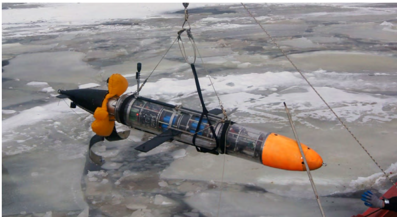
Рис. 17. Испытания АНПА в ледовых условиях (пролив Бьеркезунд), зима 2017 года). Аппарат показан после тестового срабатывания аварийного понтона.
