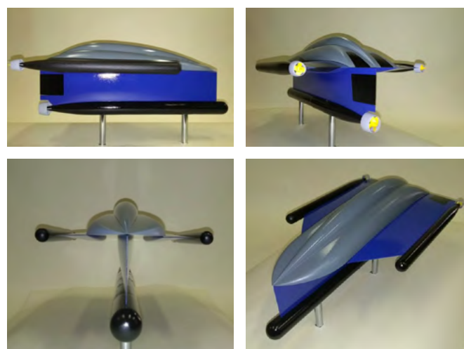
Рис. 14. Архитектурно-конструктивный вид концепта тяжёлого гибридно подводно-надводного робота - сейсмоисточника - носителя группы автономных необитаемых подводных аппаратов - сейсмоприёмников.
