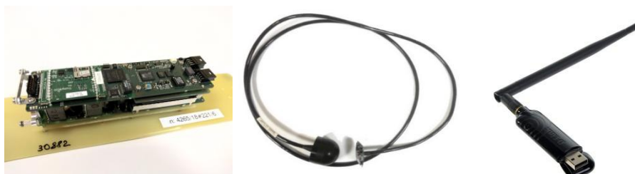
Рис. 3. Слева направо: сборка плат электроники и антенна гидроакустического модема EvoLogics S2CM 42/65 OEM; радиомодуль WiFi D-Link DWA-137/A1
