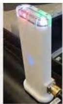
Модуль связи и вертикальный киль-мачта с сигнальными светодиодами и антеннами GPS/ Wi Fi.
