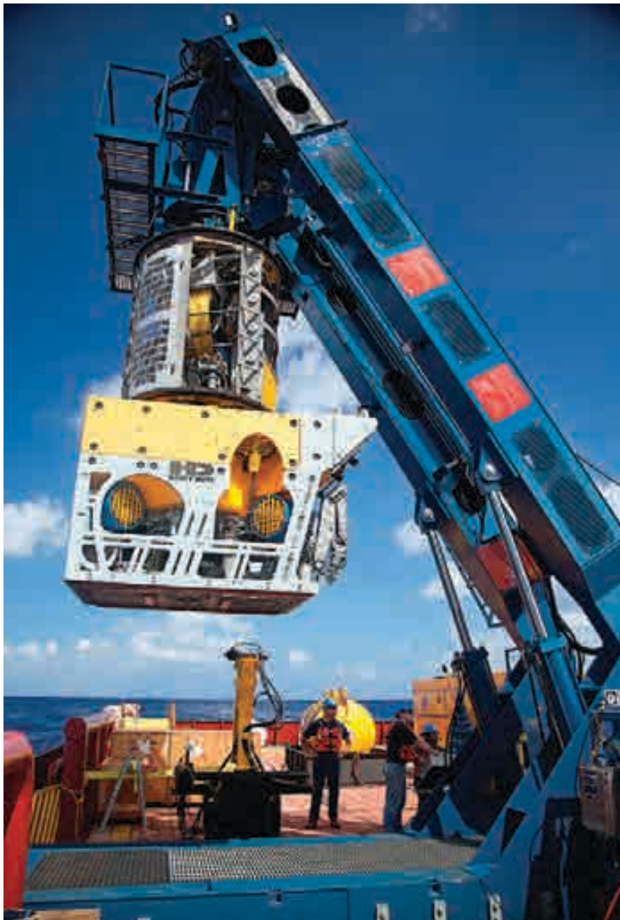
Рис. 1 Телеуправляемый подводный аппарат рабочего класса (РТПА) Schilling HD
