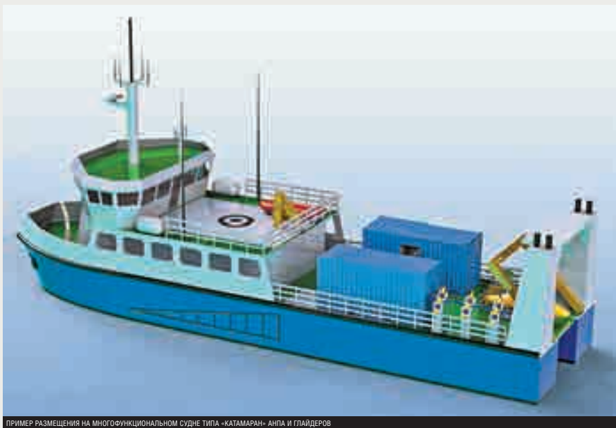
ПРИМЕР РАЗМЕЩЕНИЯ НА МНОГОФУНКЦИОНАЛЬНОМ СУДНЕ ТИПА «КАТАМАРАН» АНГА И ГЛАЙДЕРОВ
