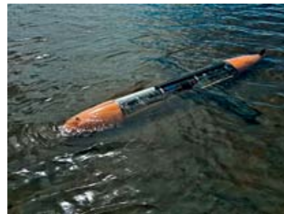
Рис. 2 Глайдер в ходе испытаний на открытой воде. Видны крылья и стабилизаторный блок
