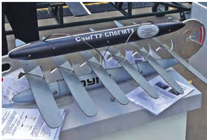
Подводный модуль опытного образца отечественного волнового глайдера СамГТУ-СПбГМТУ
