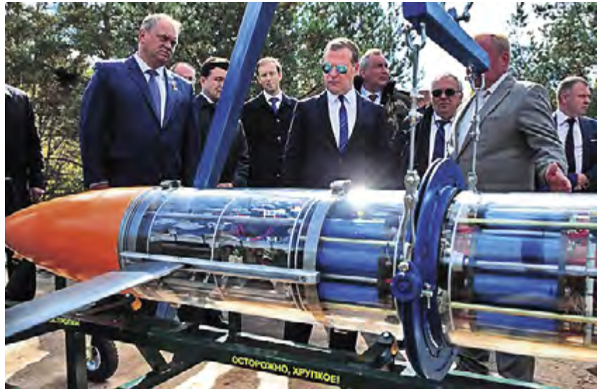
Опытный образец отечественного подводного глайдера торпедной формы второго поколения
