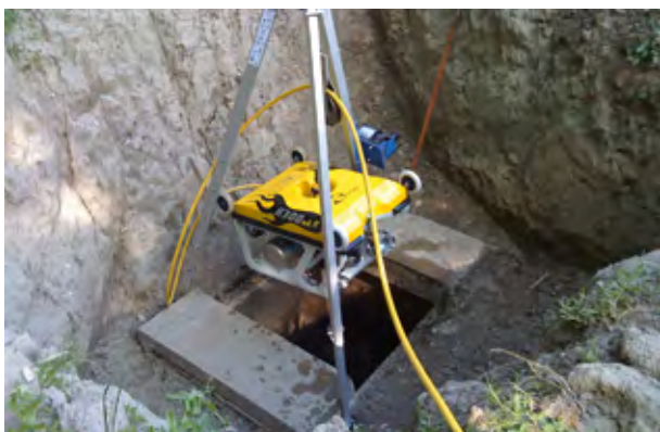
Рис. 5. ТПА Н300 идеален для инспекции узких и труднодоступных участков
