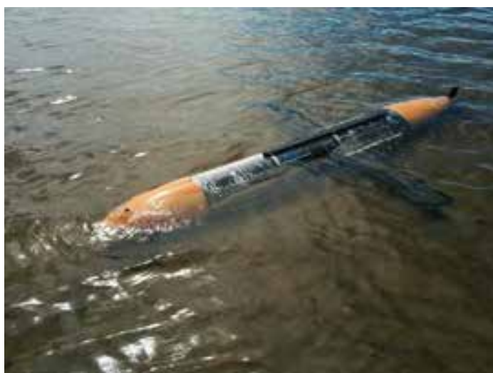
Рис. 3. Глайдер в ходе испытаний на открытой воде. Видны крылья и стабилизаторный блок.
