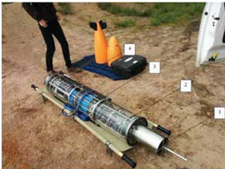
Рис. 2. Глайдер в ходе предпусковой проверки со снятыми обтекателями и крыльями (носом к камере). Видны: 1 – носовой механизм изменения плавучести, 2 – носовой отсек электроники блока полезной нагрузки, 3 – перемещаемые аккумуляторные батареи, 4 – блок электроники управления
