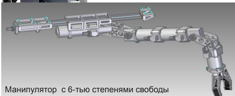
Стенд-манипулятор для отработки алгоритмов системы управления манипулятора
