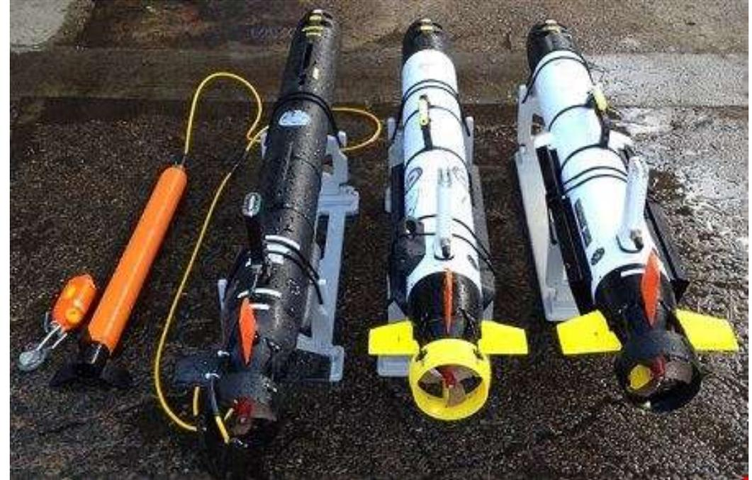
АНПА OceanServer Iver в различных вариантах полезной нагрузки
