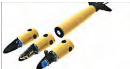
Пример проекта модульного исполнения глубоководного планера
