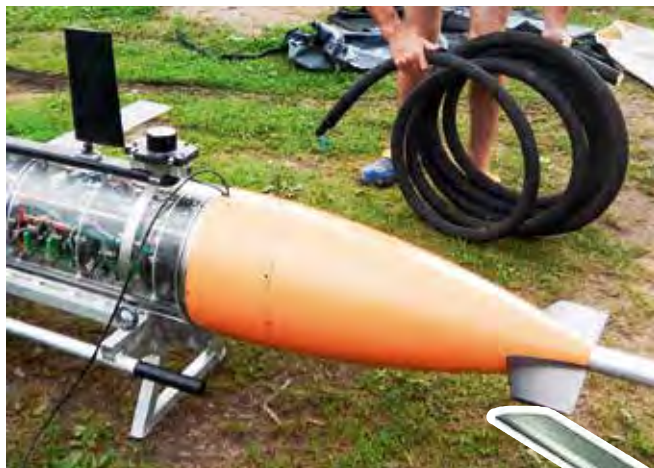
Глайдер готовится к испытанию на открытой воде
