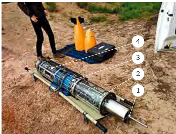
Глайдер в ходе предпусковой проверки со снятыми обтекателями и крыльями (носом к камере)
