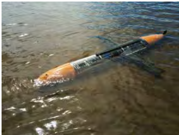
Глайдер в ходе испытаний на открытой воде. Видны крылья и стабилизаторный блок
