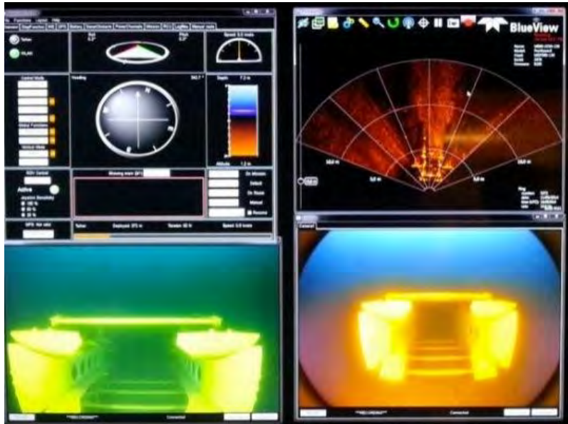
Sabertooth входит в док-станцию в автономном режиме
