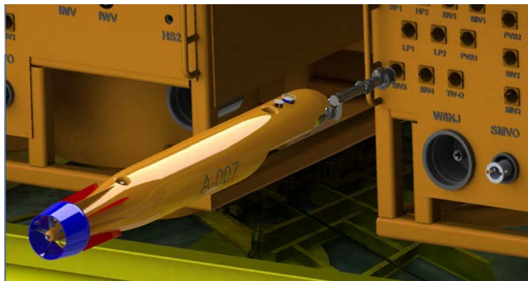
Концепт-проект СПбГМТУ и АО "НПП ПТ "ОКЕАНОС" АНПА с манипуляторным комплексом (на примере устьевой донной арматуры TechnipFMC)
