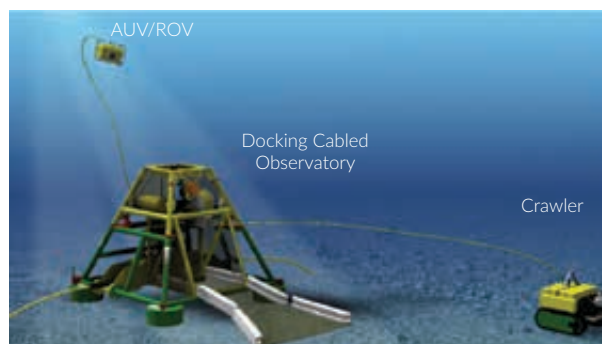
Рис. 9. Концепт инфраструктуры резидентной робототехники (New high-tech flexible networks for the monitoring of deep-sea ecosystems, 2019 г.)
