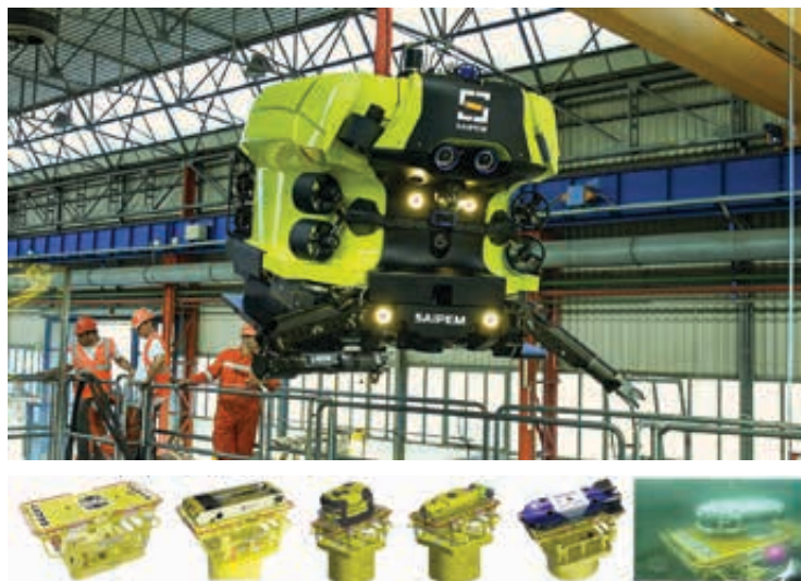
Рис. 8. Первый коммерческий подводный резидентный интервенционный гибридный необитаемый подводный аппарат Hydron-R и универсальная подводная доковая станция (для резидентных интервенционных НПА компаний Saipem, Saab Seaeeye, Oceaneering)
