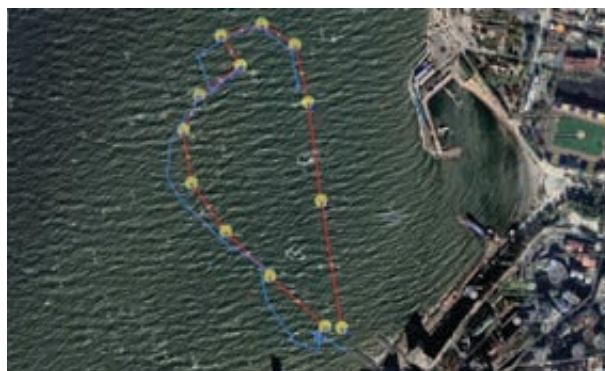
Рис. 11. Результаты испытаний «Прохождение ключевых точек в бухте по заданным координатам»
