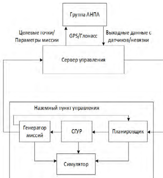
Рис. 7. Структурная схема системы группового управления гетерогенной группой робототехники.
