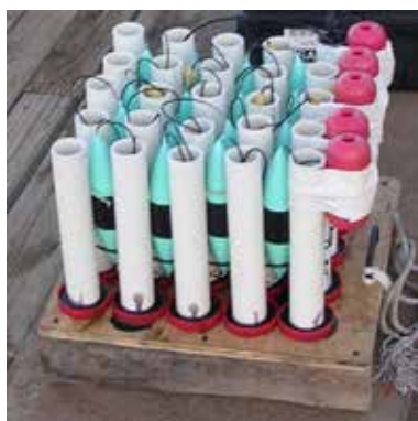
Рис. 8. Контейнер для хранения ГПБА и вертикальное положение ГПБА в эксперименте с глайдером
