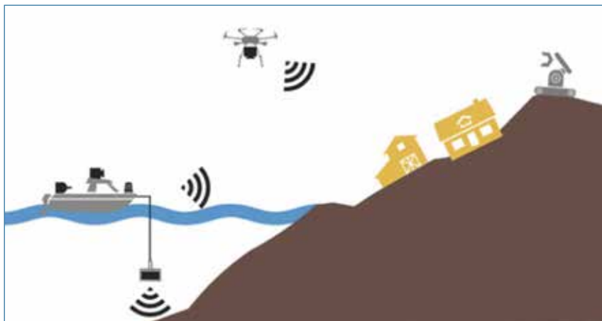
Схема работы гетерогенной группы РТК, занятой мониторингом и патрулированием
