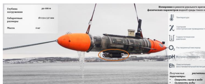
Рис. 8. Экспериментальный образец отечественного блока датчиков многоканальной гидрохимикофизической измерительной системы ("NAECO") установленный на подводном глайдере из состава гетерогенной группы МРТК
