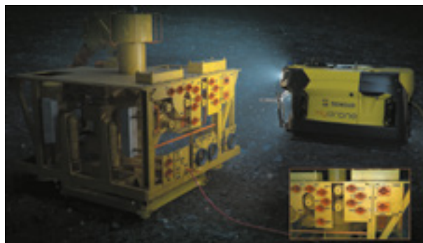
Составляющие платформы Hydrone и визуализация работы НПА Hydrone-R с рабочей панелью подводного добывающего комплекса (ПДК)
