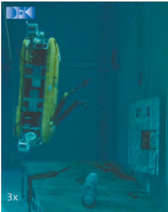
Подводный интервенционный АНПА Mare-IT в ходе выполнения сервисных работ на макете рабочей панели ПДК [22]
