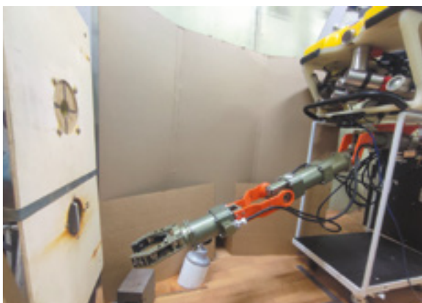
Процесс отладки сопряженного функционирования манипуляторного комплекса и системы технического зрения для автономного выполнения работ с макетом панели ПДК
