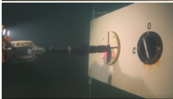
ЛИ АНПА в процессе взаимодействия с макетом рабочей панели ПДК при передаче данных управления и видеопотока через модуль беспроводной оптической системы подводной связи
