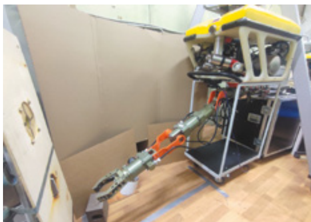
Процесс отладки сопряженного функционирования манипуляторного комплекса и системы технического зрения для автономного выполнения работ с макетом панели ПДК
