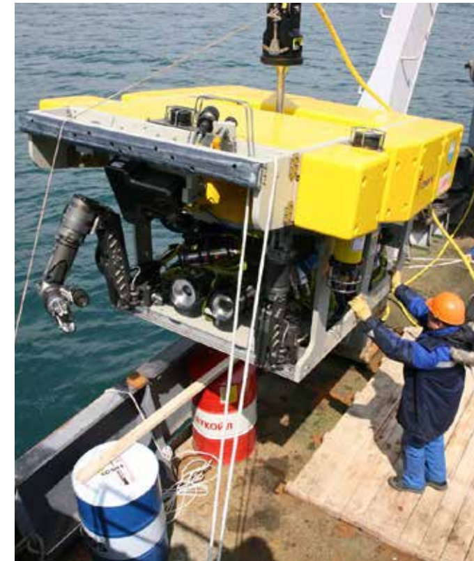
Рис. 2 Типичный представитель ТНПА форм-фактора «кирпич» для донных исследований, как видно, с ним «не разгонишься»
