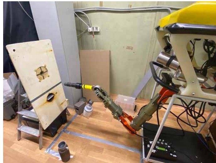
Рис. 7. Отработка автоматических операций отечественного подводного манипуляторного комплекса с использованием искусственного интеллекта в СТЗ и САУ манипуляторного
