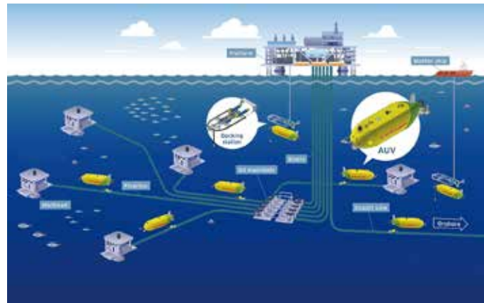
Рис. 5 Инфографика по действующему МРТК резидентного базирования в толще воды на базе АНПА для обследования МПТ
