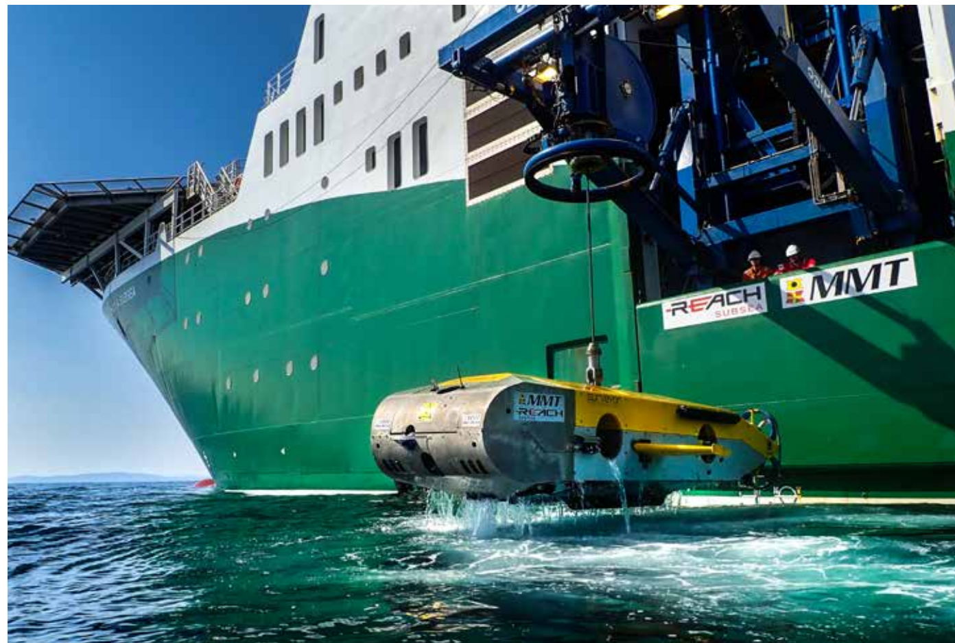
Рис. 1 Специализированный ТНПА для обследования трасс МПТ с улучшенными ходовыми (скоростными) качествами
