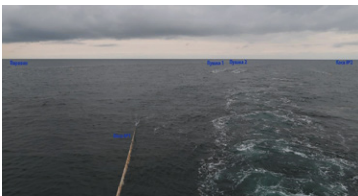
Рис. 27. Выпуск двух сейсмокос, оснащенных навесным оборудованием для позиционирования на НИС «Академик Немчинов». 2023 г. Баренцево море
