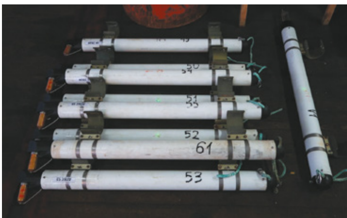
Рис. 26. Подготовка навесных устройств (транспондеров и навесных велосиметров — измерителей скорости звука в воде) к вывеске на НИС «Академик Немчинов». 2023 г. Баренцево море
