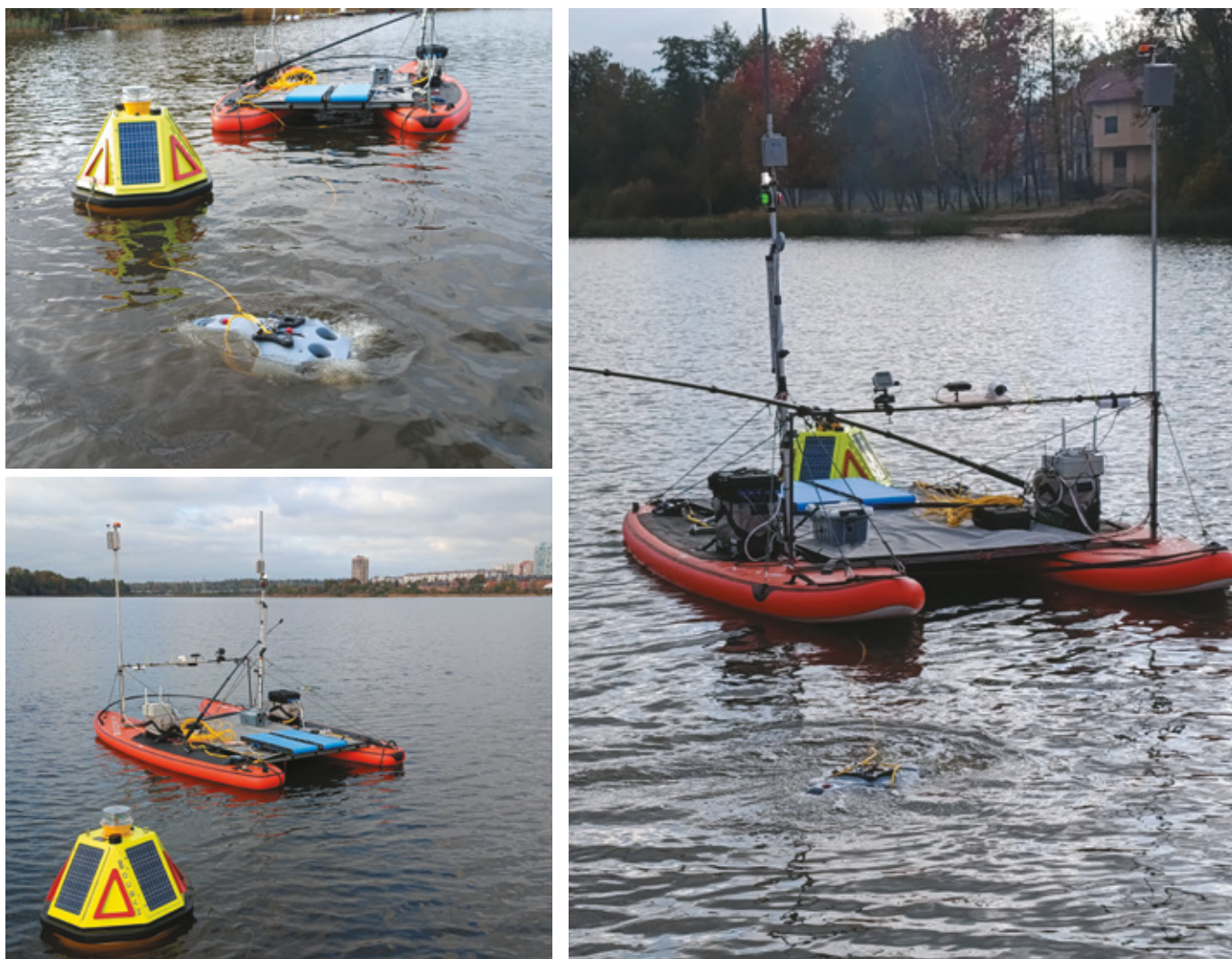
Рис. 14. МНС «Лощман» при выполнении сброса и ретрансляции управления и телеметрии с мини-ТНПА на пункт управления оператора
