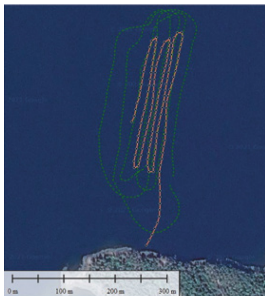
Рис. 8. Испытания ПАК АСДС в Белом море (Кандалакшский залив, район о. Высокий). Июнь 2019 г. Пунктирная зеленая линия — трек, состоящий из выстрелов пингера. Черные точки — рассчитанные положения датчиков. Оранжевая линия — линия косы
