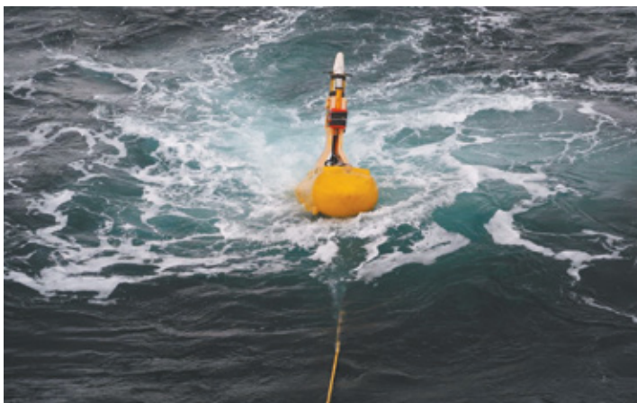
Рис. 25. Концевой буй сейсмокосы, оснащенный модулем дальномерной навигации и акустическим транспондером концевой буга. 2021 г. Балтийское море, НИС «Академик Немчинов»
