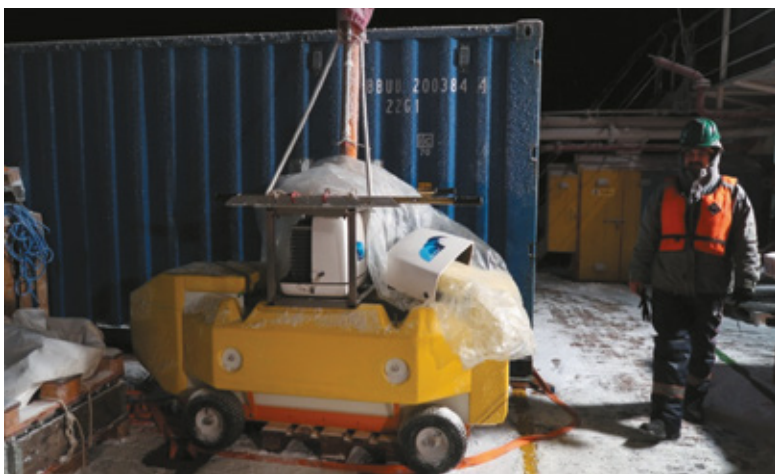
Рис. 6. Испытания ПАК АСДС в Баренцевом (Печорском) море, район Приразломной, НИС «Оникс». Подготовка радиобуя
