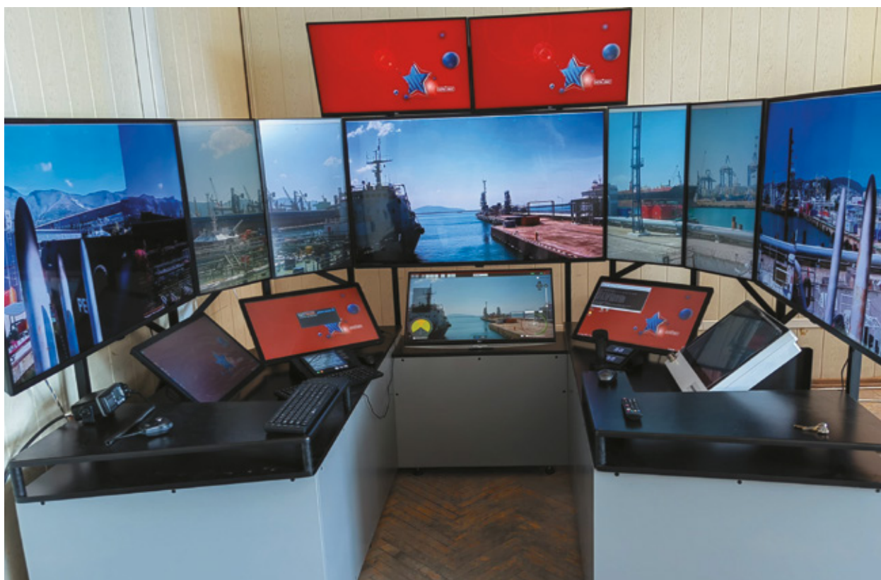
Рис. 2. Вариант реализации поста дистанционного управления (ФГБОУ ВО «ГМУ им. адм. Ф.Ф. Ушакова»). Испытания оборудования
