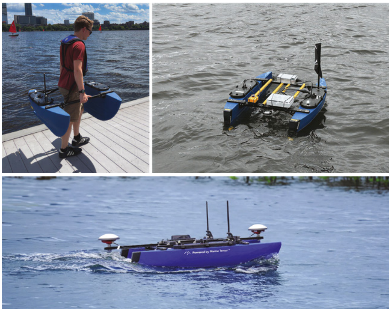
Рис. 5. БЭК катамаранного типа BlueBoat. Спускоподъемные работы осуществляются одним человеком
