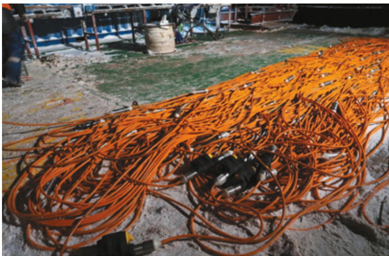
Рис. 5. Испытания ПАК АСДС в Баренцевом (Печорском) море, район Приразломной, НИС «Оникс». Подготовка сейсмокоды
