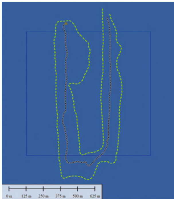
Рис. 10. Испытания ПАК АСДС в Обской губе, НИС «Картеш». Сентябрь 2019 г. Сплошная синяя линия — полигон работ (900 x 900 м). Пунктирная зеленая линия — трек, состоящий из выстрелов пингера. Черные точки — результат позиционирования каждого датчика сейсмокося. Желтый треугольник — радиобуй. В ходе позиционирования пингер излучает 1 раз в 2 с импульс длительностью ~20 мс
