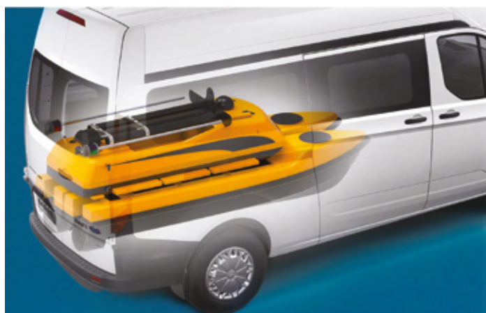
Рис. 4. Катамаран ME120 производства OceanAlpha и его расположение в фургоне
